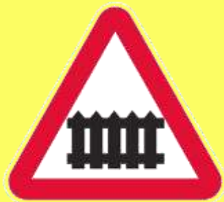
Железнодорожный переезд со шлагбаумом
