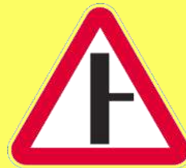
Примыкание второстепенной дороги
