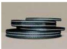
Представляет собой цветную тканую ленту, в которую вплетены светоотражающие нити, различных ширин. Ткань серебристо-серая, представляет собой совокупность стеклянных микролинз с высокой светоотражающей способностью, внедрённых в специальный клеевой слой, нанесенный на хлопковую, нейлоновую или хлопково-полиэфирную текстильную основу. Тесьма применяется для отделки спортивной, рабочей, детской одежды, страховочных поясов, рюкзаков, сумок, обуви и т.д.
